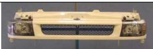
Воздухозаборная панель, отлитая из SMC
