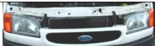
Воздухозаборная панель, отштампованная из листового металла: 19 частей и термопластичная накладка
